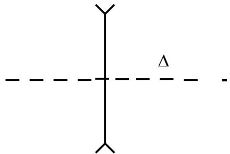
On appelle axe optique de la lentille (noté  $\Delta$ ), l'axe perpendiculaire à la lentille et qui passe par son centre optique O
