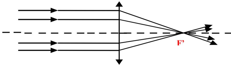
**Remarque:** on parle de **faisceau incident** pour désigner le faisceau de lumière avant la lentille et de **faisceau émergent** pour le faisceau situé après la lentille.
